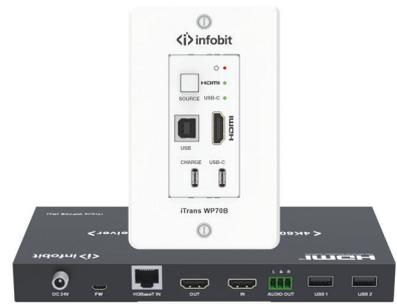
iTrans WP70Bは、壁埋込型 HDBaseT送信器(HDMI/USB-C対応)とボックス型受信器のセット。送信器は米国規格の1ギャング筐体に対応した Decoraスタイルで、壁面に設置可能です。最大4K@60Hz(4:4:4)、HDR、PoE対応。HDMI・USB-Cの2入力は自動/手動切替が可能で、さまざまなデバイスとの接続に対応します。
